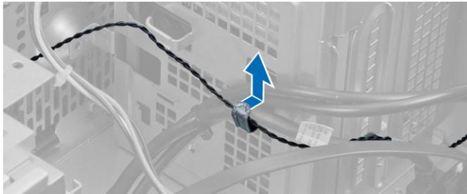
5. Presione las lengüetas en ambos lados para liberar y extraer el sensor térmico del chasis.
