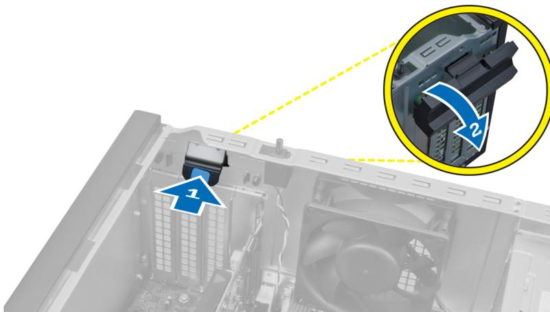
4. Tire de la palanca de liberación de la tarjeta PCIe x16 hasta que se suelte la pestaña de fijación de la hendidura de la tarjeta. Después deslice la tarjeta para sacarla de su conector y extraerla del equipo.
