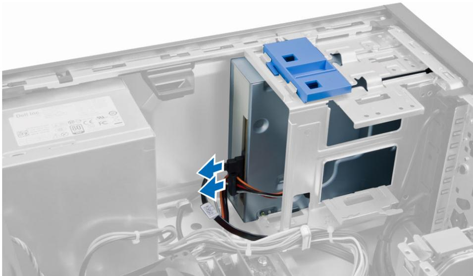
4. Deslice hacia abajo y sostenga el pestillo de la unidad óptica para desbloquear la unidad óptica y retírela del equipo.
