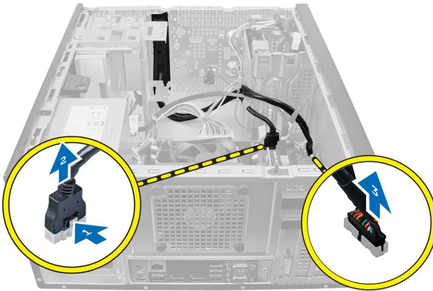
4. Desenrosque y suelte el panel de E/S, el cable de datos y el cable de datos USB del gancho del equipo.
