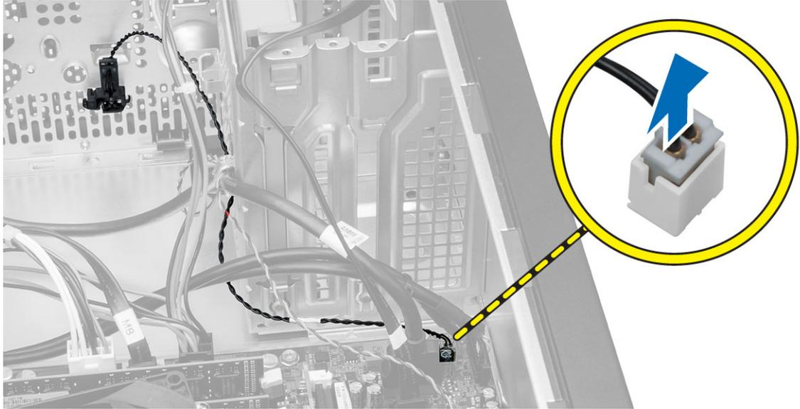
4. Libere el cable del sensor térmico del enganche del chasis.
