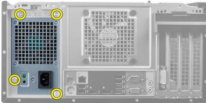
5. Presione la lengüeta de liberación azul situada junto a la fuente de alimentación y deslice la fuente de alimentación hacia la parte frontal del equipo. Levante y extraiga la fuente de alimentación del equipo.
