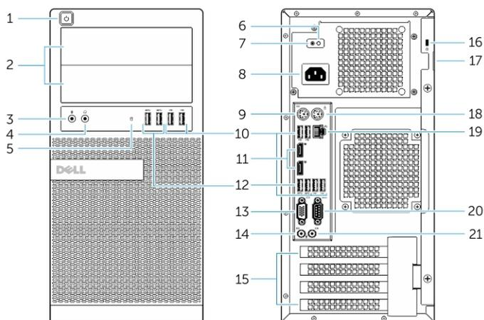
**Ilustración 1. Vista frontal y posterior de la Minitorre**
